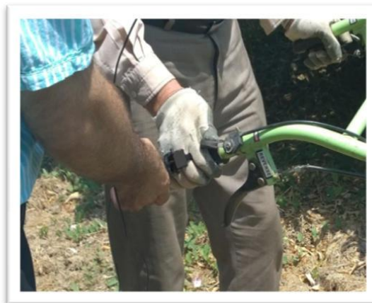
شکل ۳- ارتعاش سنج پاسخ انسانی مدل (HVM100) و نصب مبدل جهت اندازه گیری ارتعاش در جهت های x، y و z
