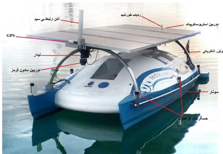
شکل ۱. برخی از تجهیزات و حسگرهای قایق خودران مروارید
