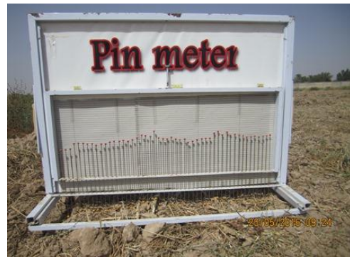
شکل ۵. ناهمواری سنج، نمای کامل (راست) نمای نزدیک از آرایش پین‌ها (چپ)
