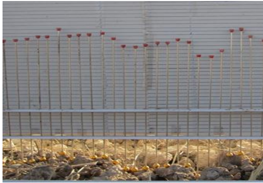
شکل ۵. ناهمواری سنج، نمای کامل (راست) نمای نزدیک از آرایش پین‌ها (چپ)
