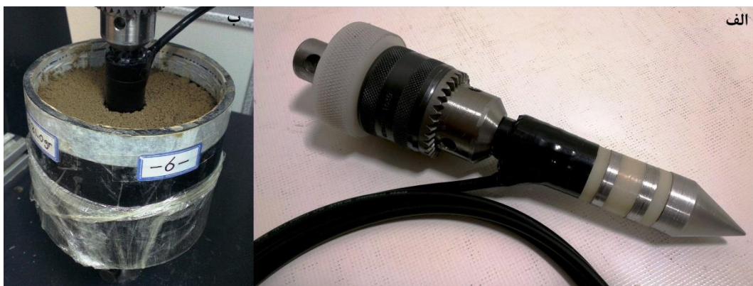
شکل ۴. الف) تصویر واقعی از حسگر خازنی، متصل به سه‌نظام ۱۳ میلی‌متری و ب) قرارگیری کامل حسگر خازنی در نمونه خاک.
