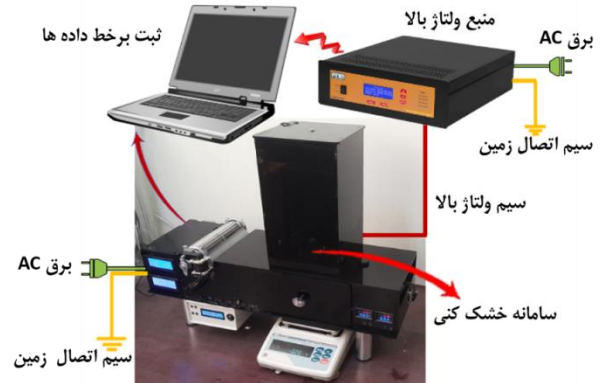
شکل ۱. طرحواره سامانه خشک‌کن توسعه داده شده
