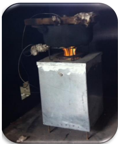
شکل ۲. عملکرد ظاهری اجاق در کار با پوست پسته
