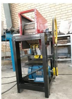
شکل ۳- طرحواره و تصویر دستگاه خردکن کود گاوی مرطوب: ۱- شاسی، ۲- واحد کوبنده، ۳- ضد کوبنده، ۴- پیچ و فنر قابل تنظیم، ۵- واحد تغذیه، ۶- یاتاقان، ۷- موتور الکتریکی، و ۸- پولی
