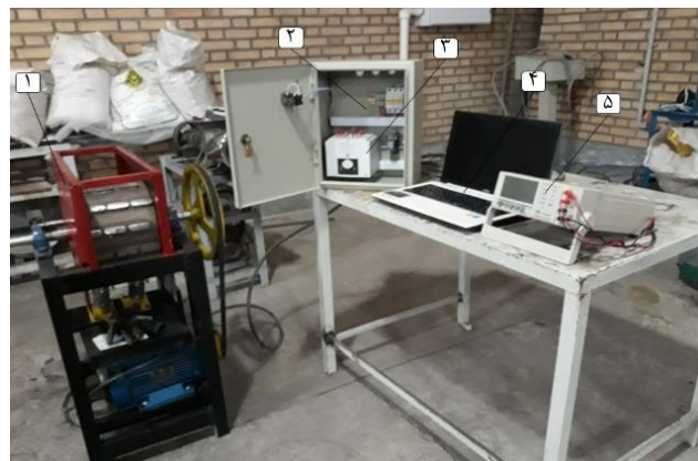
شکل ۴- دستگاه خردکن و اندازه گیری انرژی مصرفی ویژه: ۱- دستگاه خرد کن کود دامی مرطوب ۲- تابلو برق ۳- اینورتر ۴- رایانه ۵- دستگاه اندازه
