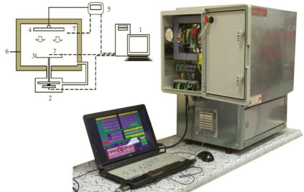
شکل ۲- سیستم خشک‌کن مادون قرمز و لوازم آن، (1) کامپیوتر (2) ترازو (3) سینی نمونه (4) تابش‌کننده سرمایی مادون قرمز با توان ۱۰۰۰ وات (5) کنترل‌کننده منطقی برنامه‌پذیر (PLC) (6) محفظه خشک‌کن (7) ترموکوپل‌ها
