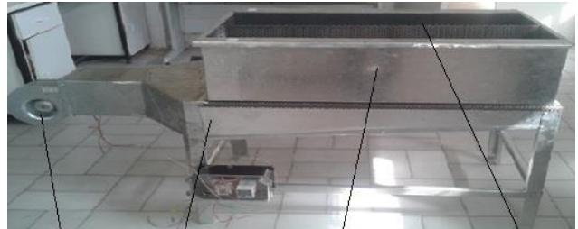
شکل ۱. خشک‌کن آزمایشگاهی شلتوک محفظه توری قابل تعویض مخزن خشک‌کن کاتال دوزنقه ای هوا دمنده
