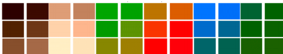
شکل ۲- کارت‌های رنگی طراحی شده برای اندازه‌گیری مقدار L^*a^*b^*
