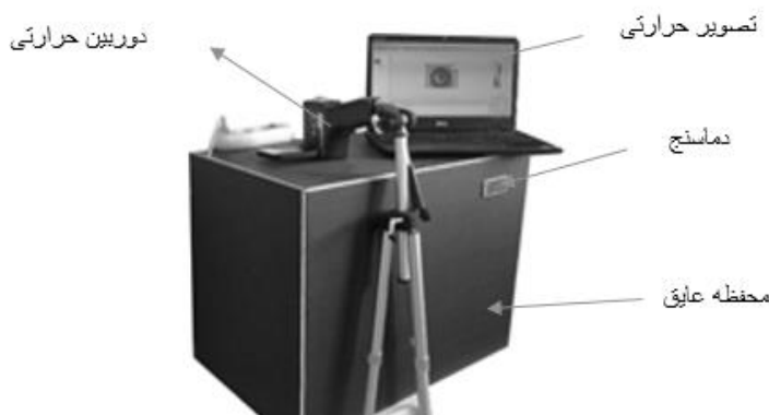
شکل ۱- مجموعه تهیه تصاویر حرارتی
