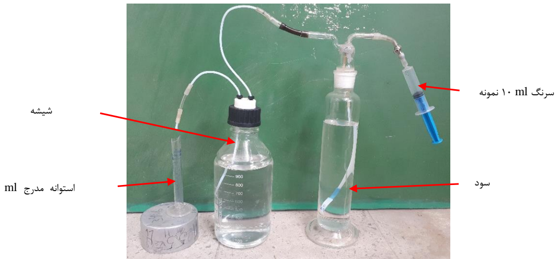
شکل ۱- سامانه سنجش محتوای متان بیوگاز شامل شیشه شستشو با سدیم هیدرواکسید ۳ مولار و سامانه جابه‌جایی آب
