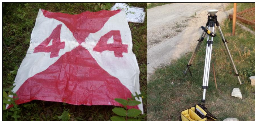
شکل ۴- نمونه‌ای از نقاط کنترل زمینی و DGPS استفاده شده در تحقیق
