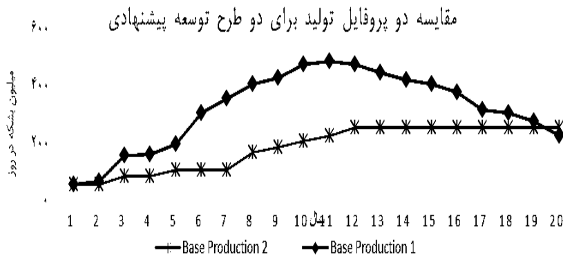
منبع: طرح‌های توسعه ارائه شده توسط شرکت‌های نفتی بین‌المللی برای یک میدان شکل ۶. تأثیر فناوری بر پروفایل تولید در طرح توسعه پیشنهادی
