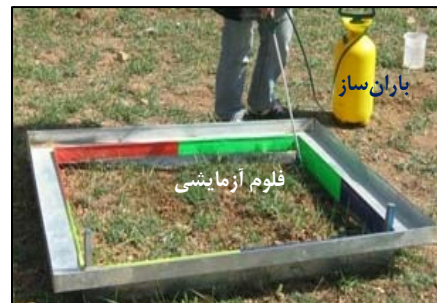
شکل 2- تصاویری از شبیه‌سازی باران و اندازه‌گیری روان‌آب با استفاده از فلوم‌های کوچک در منطقه مرتعی کدیر
