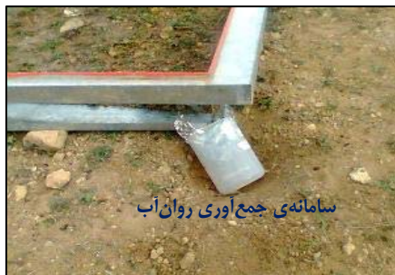
شکل 2- تصاویری از شبیه‌سازی باران و اندازه‌گیری روان‌آب با استفاده از فلوم‌های کوچک در منطقه مرتعی کدیر
