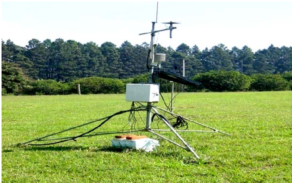
شکل ۱- نمونه تجهیزات نصب شده در ایستگاه‌های خودکار کالیفرنیا
