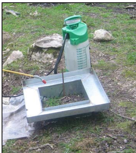
شکل ۲- باران ساز پمپی (راست) و کرت مورد استفاده (چپ) در تحقیق
