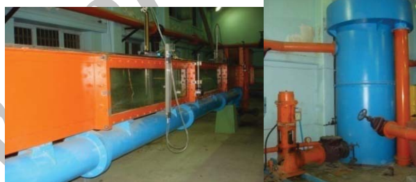
شکل ۲- نمونه‌های تجهیزات آزمایشگاهی در تحقیق حاضر به ترتیب از راست به چپ: مخزن هوایی، فلوم، سرریز مثلثی
