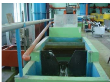
شکل ۲- نمونه‌های تجهیزات آزمایشگاهی در تحقیق حاضر به ترتیب از راست به چپ: مخزن هوایی، فلوم، سرریز مثلثی
