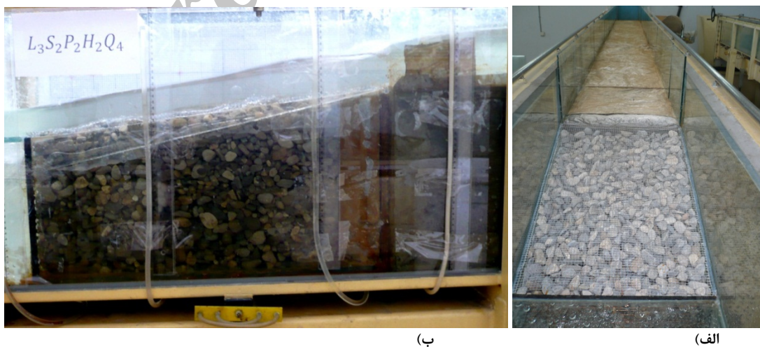
شکل ۳- فلوم آزمایش الف) آبگیر کف متخلخل و کانال بالادست آن و ب) نمای آبگیر کف متخلخل
