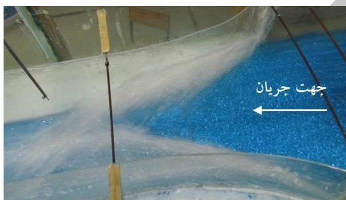
شکل 4- تشکیل امواج ضربه‌ای در تبدیل مدل 3 به ازای Fr_1 = 7
