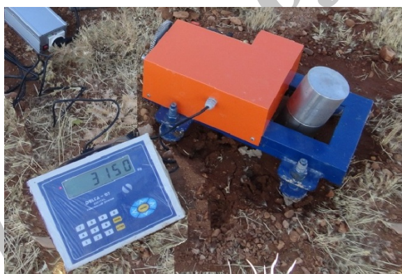
شکل ۲- دستگاه جعبه برش مستقیم هنگام اندازه‌گیری مقاومت برشی خاک در صحرا
