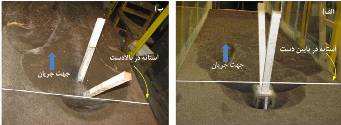
شکل ۲- نمایی از موقعیت قرارگیری آستانه در شرایط آزمایشگاهی، الف) Z/D_* = 0 و ب) Z/D_* = -1
