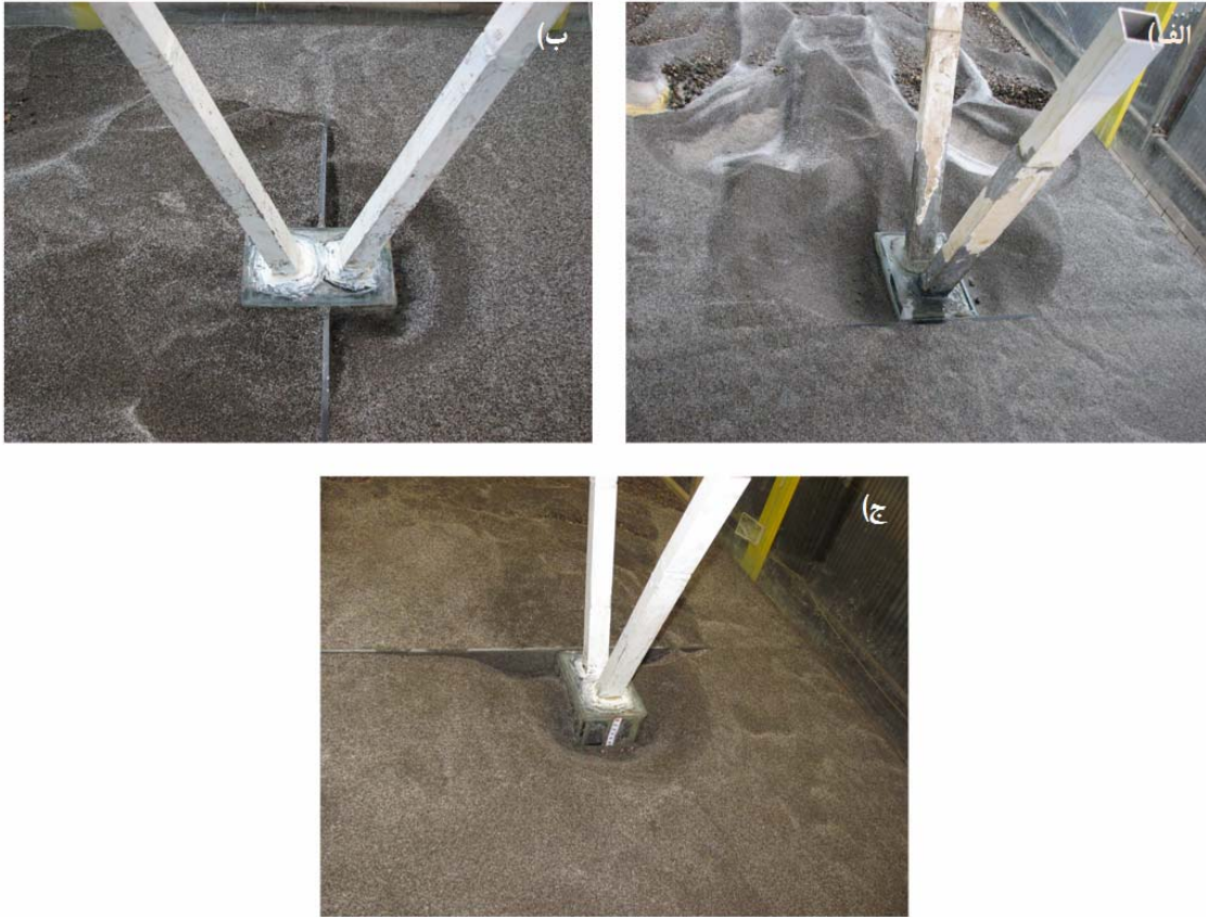
شکل ۱۰- تصاویر ابعاد چاله آبشستگی در تراز کارگذاری Z/D_* = 0 ، عمق نسبی y/D_* = 1 و سرعت نسبی 0.95 ، (الف) آستانه جلویی، (ب) آستانه میانی و (ج) آستانه انتهایی
