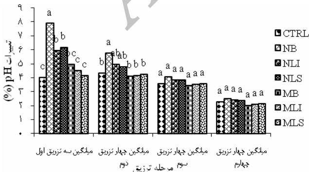
شکل ۱۳- درصد تغییرات pH پساب در دوره‌های مختلف تزریق پساب
