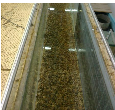
شکل ۴- کانال آزمایشگاهی و نحوه آرایش زبری ها
