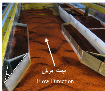
شکل ۲- نمایی از فلوم مورد استفاده به همراه تبدیل کاهش عرض Figure 2- A picture of applied flume with reduced width transition
