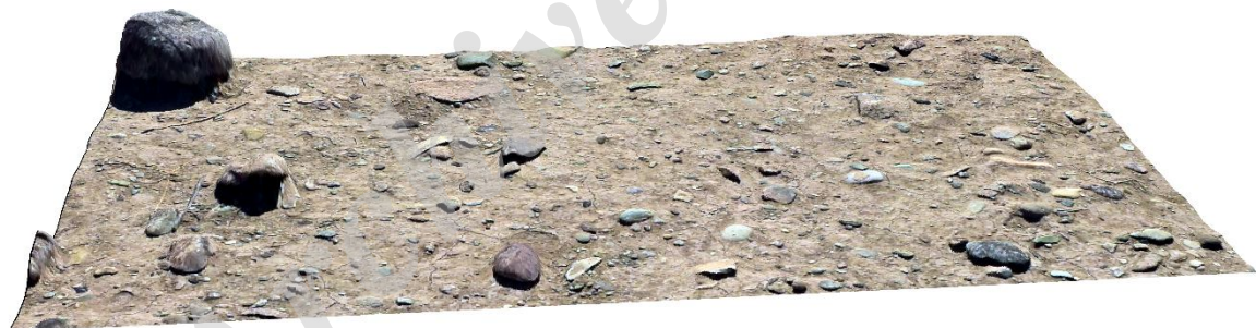
شکل 8- مدل سه بعدی سطح زمین حاصل تحلیل فوتوگرامتری در نرم افزار PhotoScan Figure 8- Three-dimensional terrain model by photogrammetric analysis in PhotoScan
