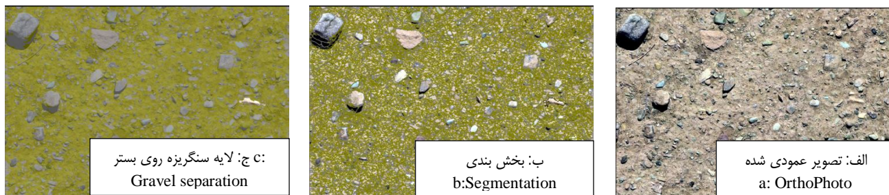
شکل 10- مراحل طبقه‌بندی شیء‌گرا در نرم افزار eCognition (تصویر ب بخش‌بندی و تصویر ج طبقه‌بندی نهایی) Figure 10- Object based classification process in eCognition software, (a) orthogonal image, (b) segmentation, and (c) Final classification
