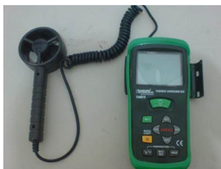
شکل 3- نمایی از بادسنج دستی دستگاه تونل باد Figure 3- The Handheld anemometer of wind tunnel
