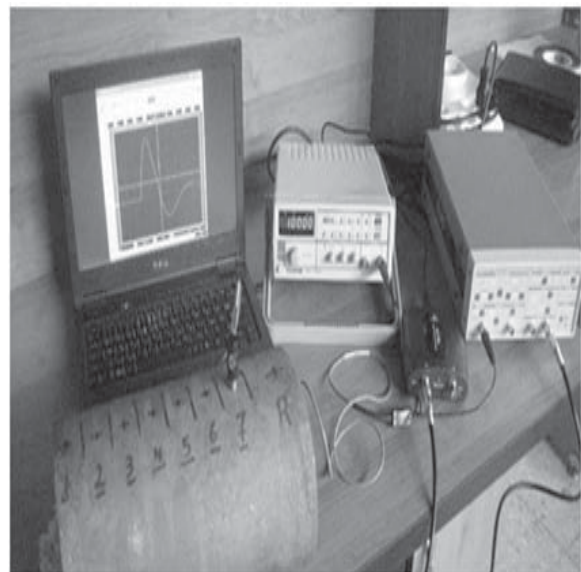
شکل ۵- سیستم و تجهیزات آزمون جریان گردابی گذرا
