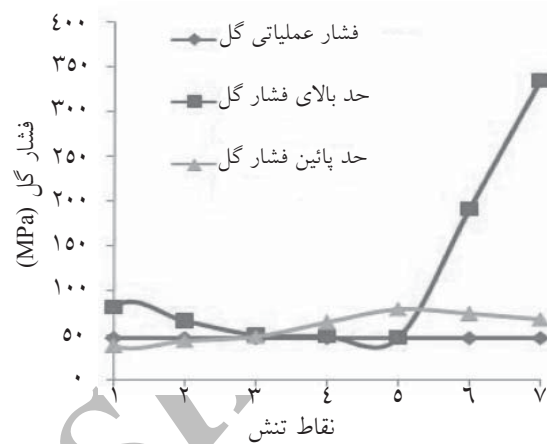
شکل ۲- حد پایین و بالای فشار گل در هر یک از حالات تنش
