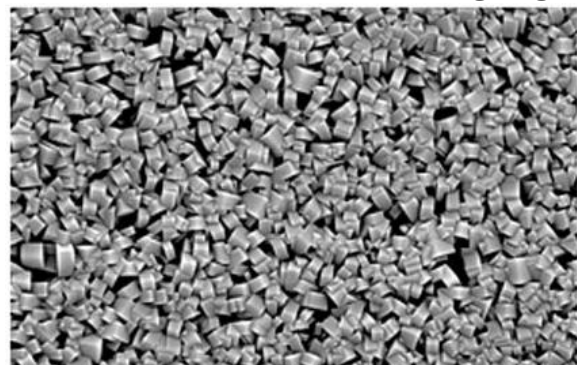
شکل ۱۳- SEM سطح فیلم در غشاء M17-0.85
