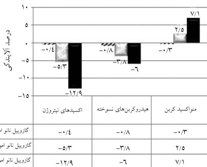
شکل ۲- مقایسه درصد میانگین آلاینده‌های سوخت گازوییل نانو امولسیونی خروجی از اگزوز دیزل OM314 نسبت به سوخت پایه
