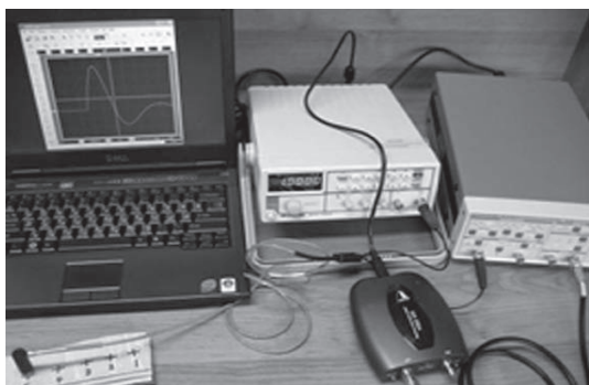
شکل ۱۰- تست ترک‌یابی از روی سه لایه عایق
