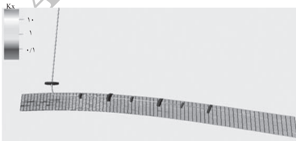
شکل ۲-ج) مقطع عرضی توزیع تراوایی مخزن (روی محور Z)
