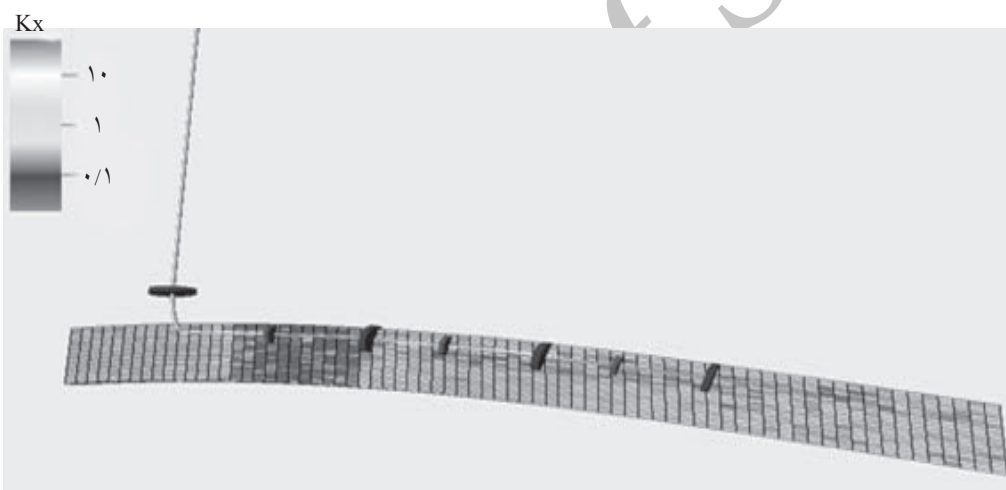
شکل ۲-ب) مقطع عرضی توزیع تراوایی مخزن (روی محور Y)
