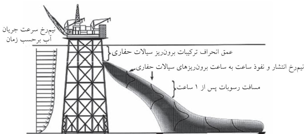
شکل ۶- نیمرخ نحوه نفوذ، انتشار و رسوب سیالات و دورریزهای حفاری پس از تخلیه در محیطهای دریایی
