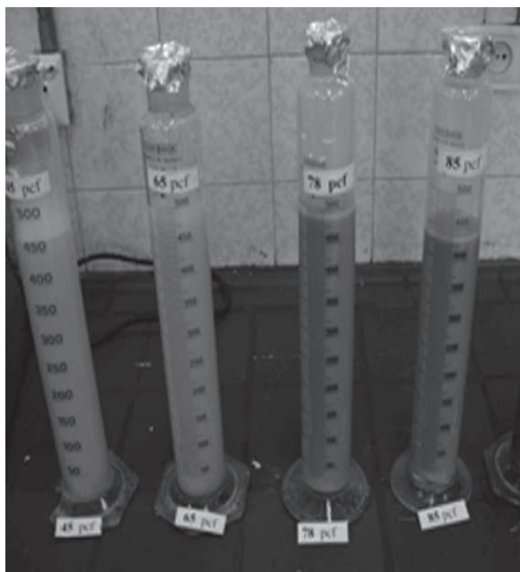
شکل ۲- اندازه‌گیری رسوب‌گذاری و رقیق‌شوندگی سیالات حفاری
