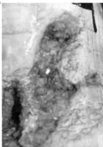
شکل ۵- نمونه شکستگی (راست) و تخلخل حفره‌ای (چپ) در مغزه‌های یکی از چاه‌های مجاور چاه مورد مطالعه
