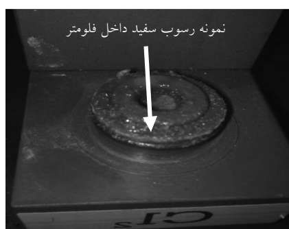
شکل ۱- کلریناتور نوع بتا مورد استفاده در مسیر تزریق کلر (رسوب‌گذاری در داخل فلومتر کلریناتور مشهود است)
