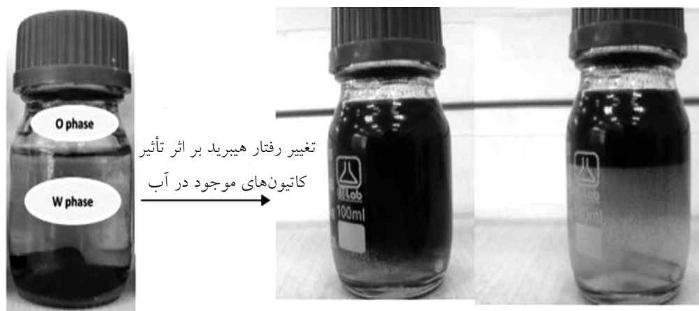
شکل ۱- تأثیر تدریجی کاتیون‌های موجود در آب بر ساختار نانو هیبرید و تغییر خاصیت آب، نفت گریز به آب، نفت دوست
