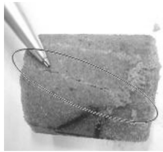
شکل ۸- شکاف ایجاد شده در مغزه شماره ۳ بعد از عملیات تزریق آب درون مغزه نگهدار
