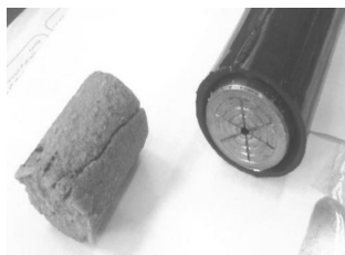
شکل ۱۳- نمونه مغزه شماره ۵ بعد از عملیات تزریق خارج شده از مغزه نگهدار
