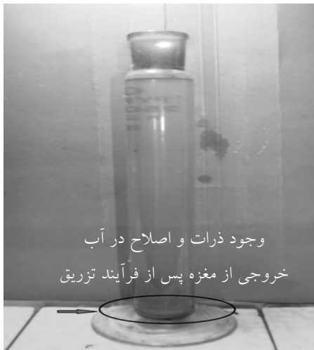
شکل ۹- سمت چپ: ذرات و املاح ته نشین شده در آب تزریقی خارج شده از نمونه مغزه تحت تزریق قرار گرفته، سمت راست: ذرات و املاح گرفته شده توسط فیلتر پس از فیلتراسیون آب تزریقی
