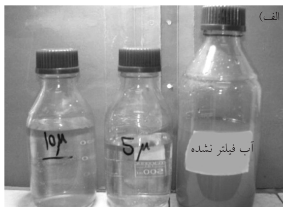
شکل ۱- الف) سه نوع آب مورد استفاده در این مقاله که به ترتیب از راست به چپ، آب فیلتر شده، آب فیلتر شده با صافی 5 \mu m و آب فیلتر شده با صافی 10 \mu m (ب) فیلترهای استفاده شده و ذرات جدا شده بر روی آنها
