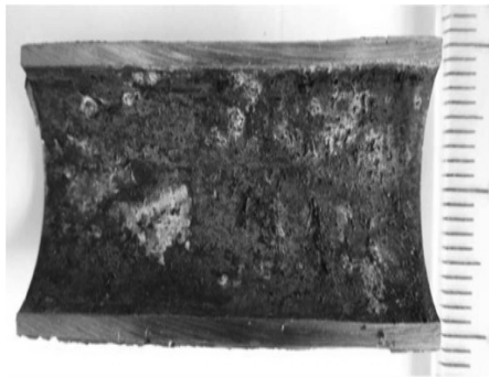
شکل ۳ تصویر سطح داخلی تیوب در ناحیه ای بین سوراخ‌های ۱ و ۲ وجود یک لایه رسوبی قهوه‌ای تیره و سفید رنگ بر روی این سطح را نشان می‌دهد.
