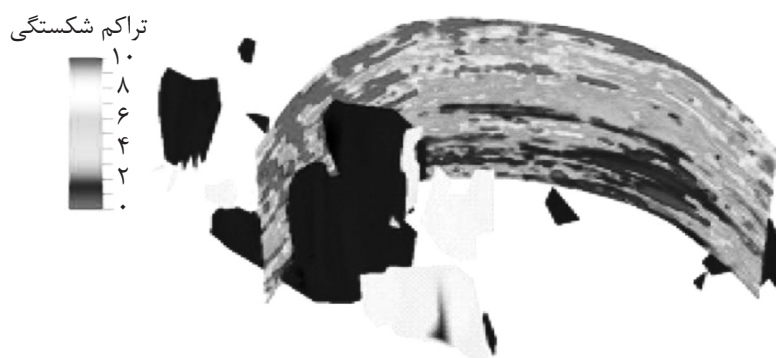
شکل ۱۲- مقطع تراکم شکستگی و شکستگی‌های حاصل از ردیابی مورچه
