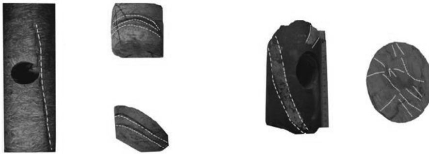
شکل ۱- نمونه‌ای از شکستگی باز (سمت چپ) و شکستگی پر شده از انیدریت و کلسیت (سمت راست) در مغزه‌های میدان مارون
