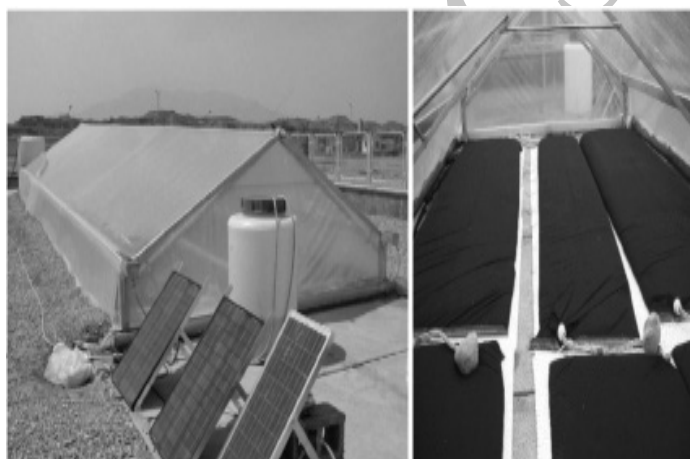
شکل ۲- تصویر واقعی سامانه نمک‌زادایی شبنم خورشیدی
