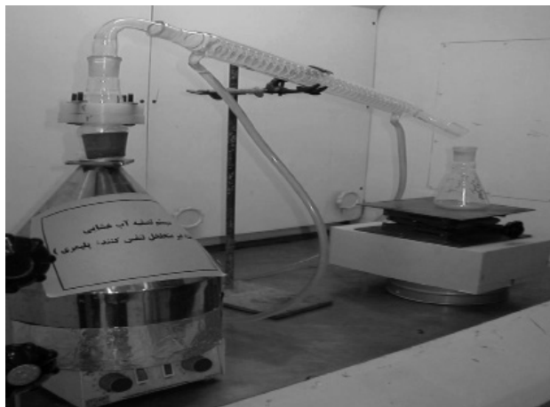
شکل ۸- سیستم ارزیابی آب خروجی از غشاء
