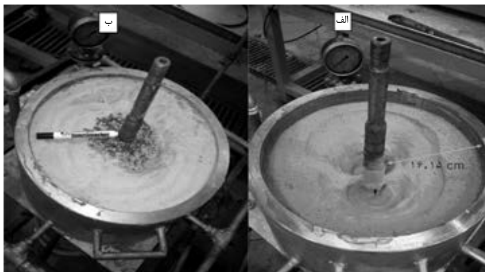
شکل ۴ الف) تصویر ماسه و گراول پک اطراف چاه و ب) تصویر عدسی‌های ایجاد شده در اطراف چاه بدون گراول.
