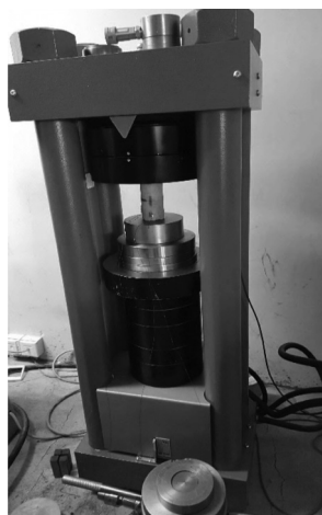
شکل ۲ دستگاه بارگذاری خودکنترل.
