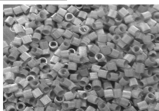
شکل ۳ همزن‌های ثابت الف- مارپیچ، ب- بفل تک بخشی، ج- ساچمه ای، د- پشم فلز، ه- پرکن توری.
