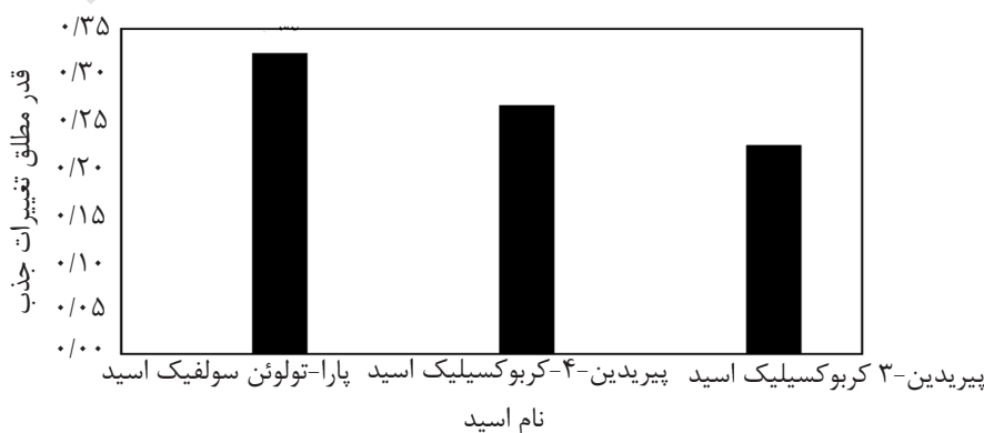
شکل ۵ قدر مطلق تغییرات جذب محلول آسفالتین-تولوئن در حضور اسیدهای دارای حلقه آروماتیک.
