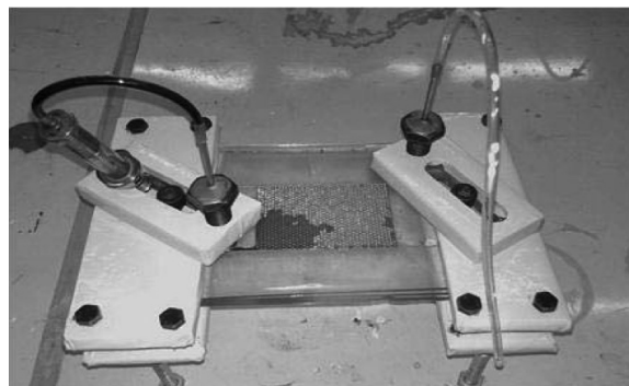
شکل ۲ میکرومدل، نگهدارنده و پورت‌های تزریق.
