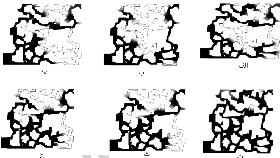
شکل ۸ تصاویر به دست آمده از توزیع پایدار شده سیالات در مدل‌های مختلف تحت اثر مکانیزم مسدودسازی انتخابی (الف) مدل ۲ (ب) مدل ۳ (پ) مدل ۴ (ت) مدل ۵ (ث) مدل ۶ (ج) مدل ۷
