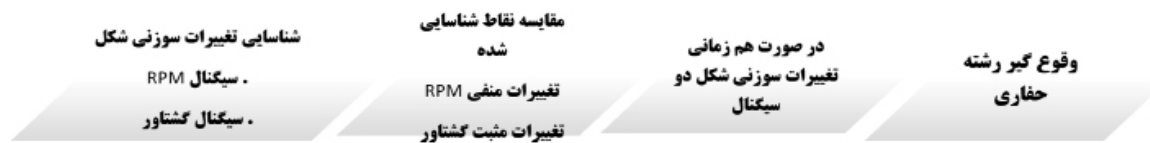
شکل ۲ مراحل شناسایی گیر رشته حفاری از طریق تحلیل سیگنال گشتاور
