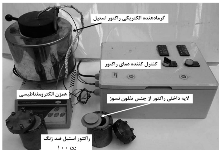
شکل ۲ سامانه آزمایشگاهی برای انجام واکنش و تبادلی استری (واکنش تولید بیودیزل)
