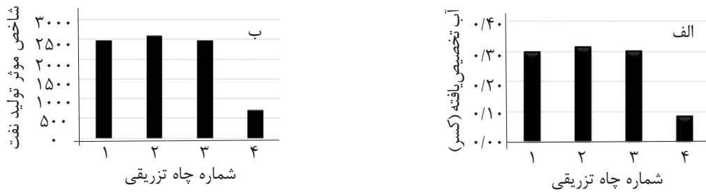
شکل ۵ الف) کسر آب تزریقی اختصاص یافته به هر چاه تزریقی، ب) شاخص موثر تولید نفت برای هر یک از چاه‌های تزریقی
